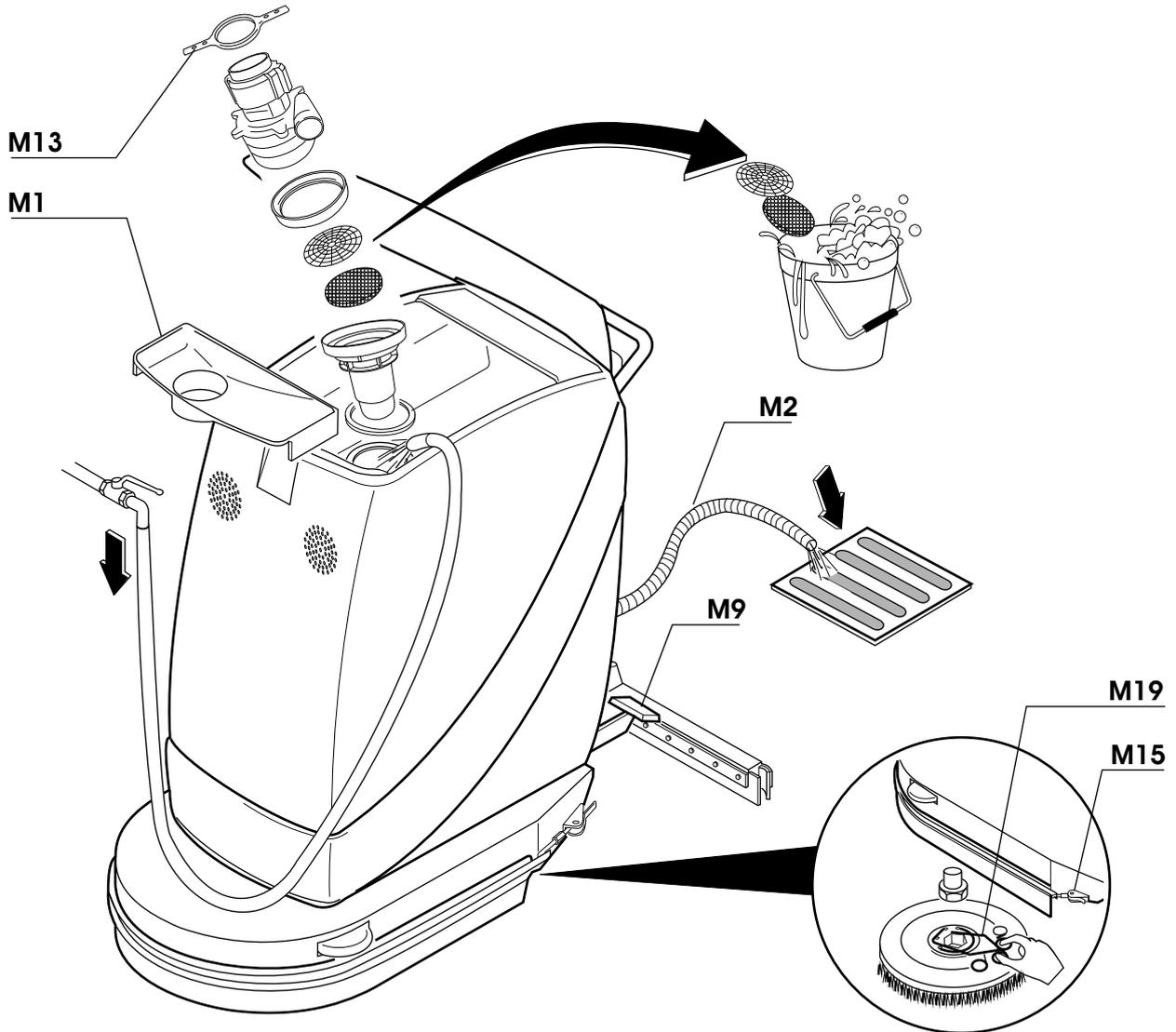
mente filtro, rete e spugna, e rimuovere lo sporco che si è depositato nel serbatoio, scaricandolo dal tubo M2.
