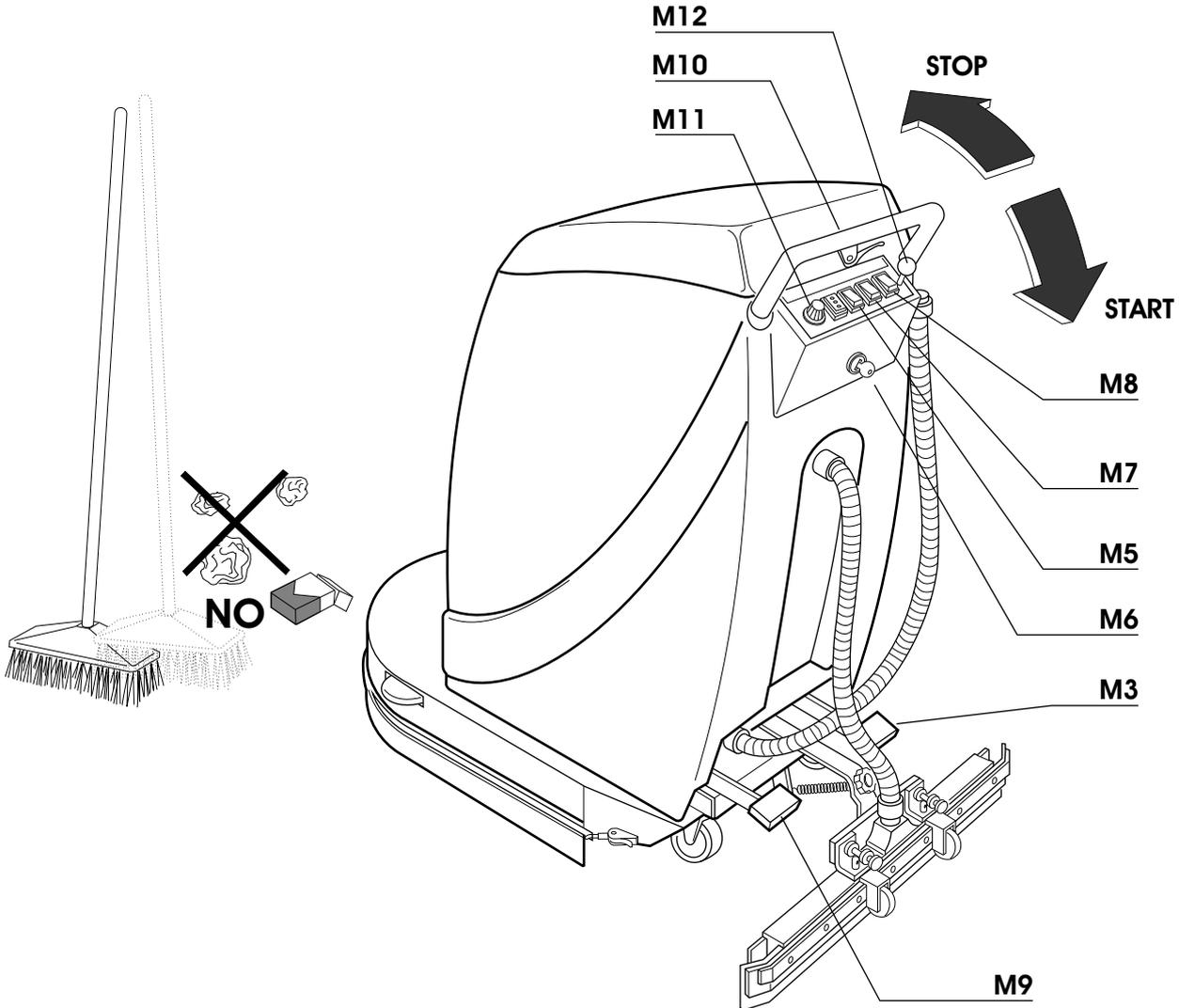
In ogni caso si può procedere ad una prima passata veloce con il tergipavimento sollevato e la spazzola in posizione di lavoro; in tal modo la soluzione detergente verrà lasciata sul pavimento più a lungo e potrà sciogliere lo sporco più tenace. La seconda passata va effettuata con spazzola e tergipavimento entrambi abbassati e ad una velocità più lenta.
